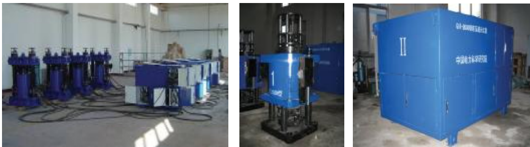
图2 GYT-200D 型液压提升装置
