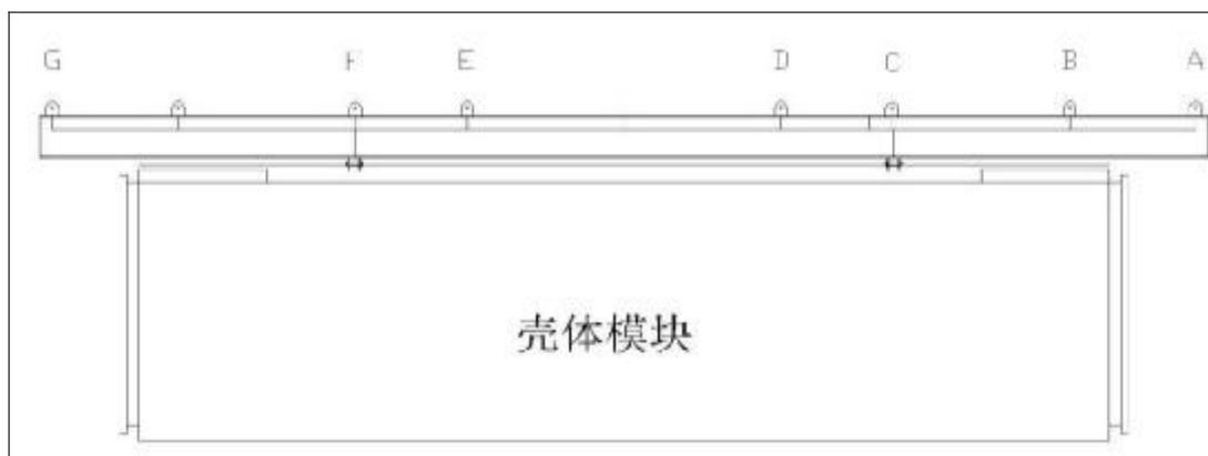
图 1 壳体模块吊装平衡梁示意图
