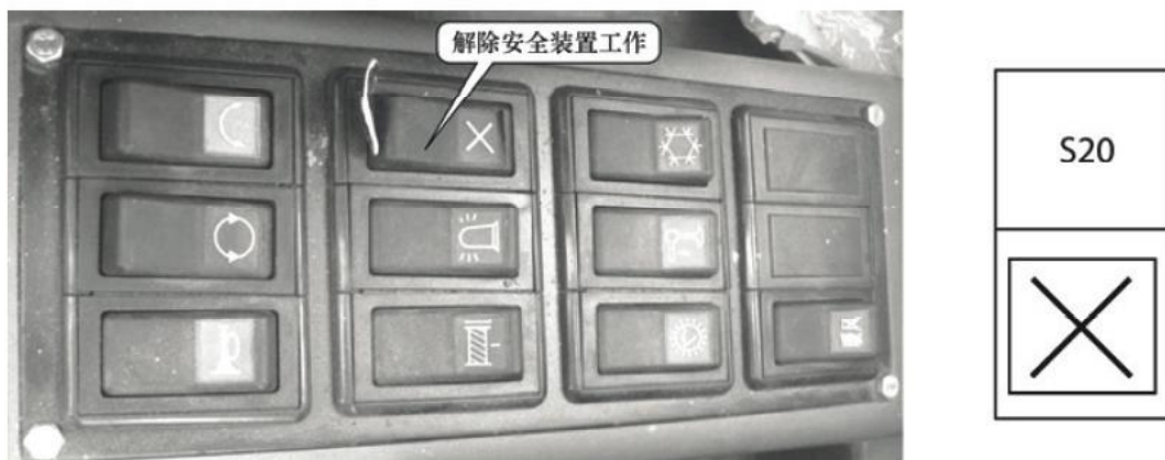
图6 徐工汽车起重机过载解除开关
