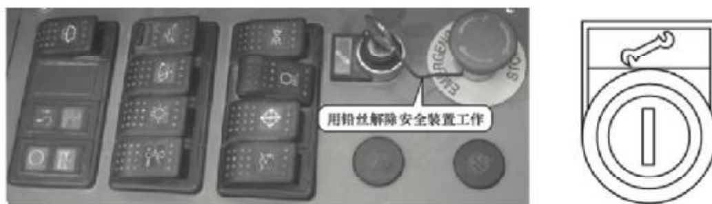
图7 中联重科汽车起重机强制释放开关
