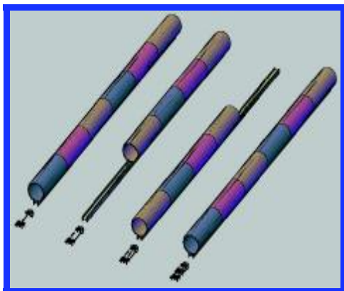
锡杖钢管去头加尾法找直示意图
